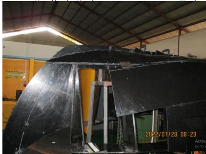
Gambar 1. Plat HDPE Bagian Haluan Prototipe Kapal Nelayan Tradisional
