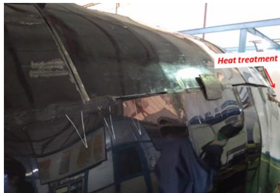
Gambar 8. Proses Heat Treatment Dengan Menggunakan Thermoplastic Welding
