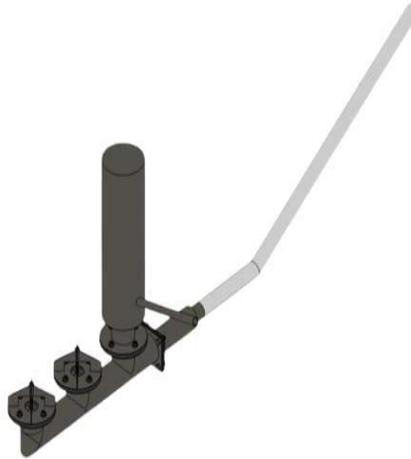
**Gambar 9. Hasil Desain Pompa Hidram Dengan 2 Katup Lurus Siku**
