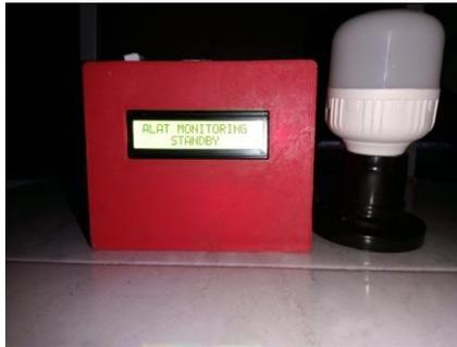
**Gambar 7. Alat Monitoring Energi dan Biaya Listrik**
