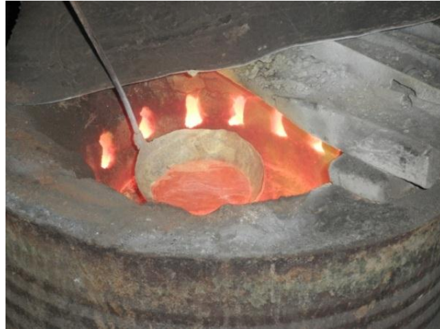
Gambar 6. Peleburan logam alumunium dengan dapur crucible
