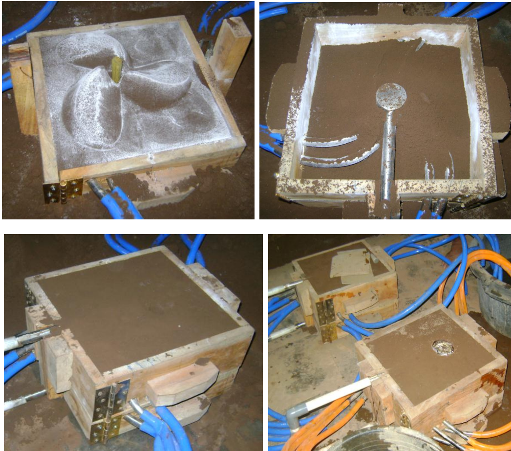
Gambar 10. Proses pengecoran cetakan pasir dengan chiller pendingin
