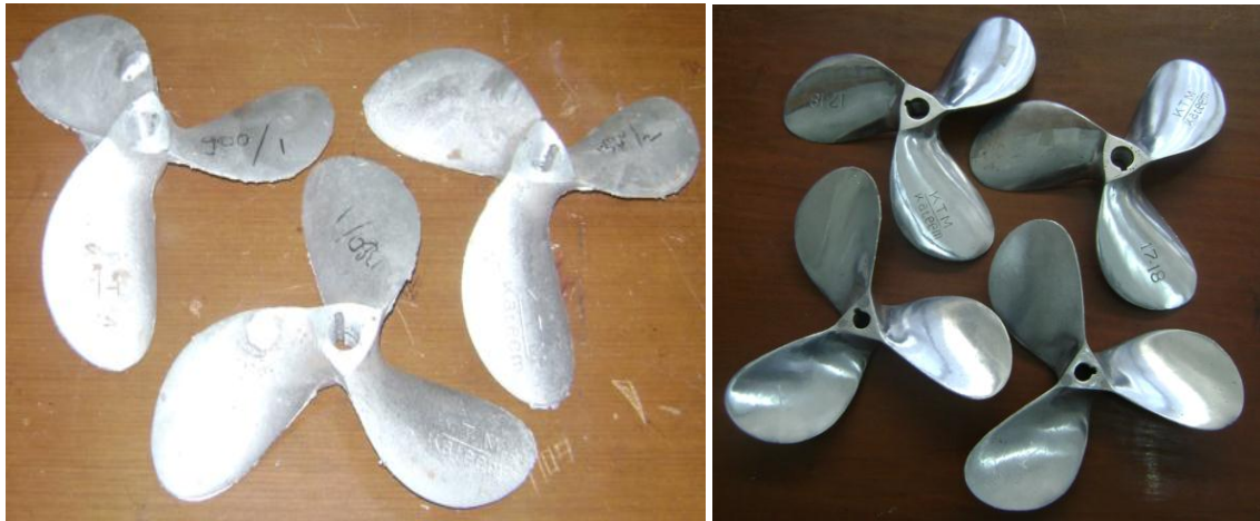
Gambar 12. Hasil pengecoran sebelum dan setelah proses finishing
