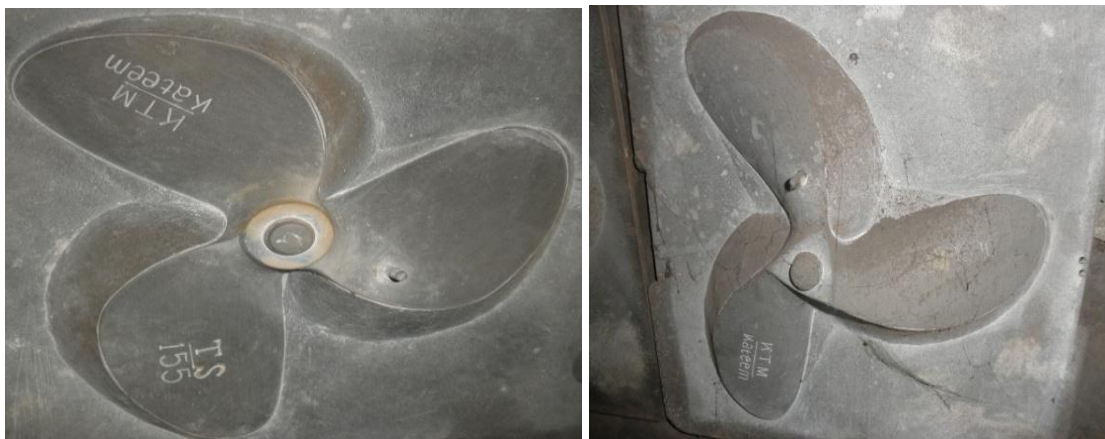
Gambar 7. Pengecoran dengan pasir cetak
