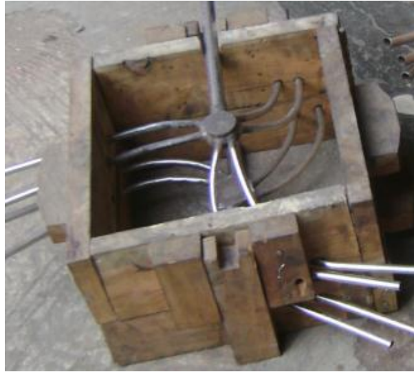
Gambar 9. Desain cetakan cor
