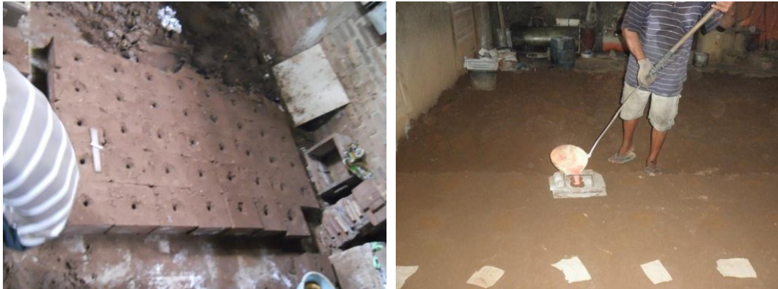
Gambar 7. Pengecoran dengan pasir cetak
