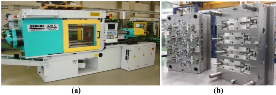
**Gambar 1. (a) Mesin Injection Mold, (b) Cetakan Plastik [3]**
