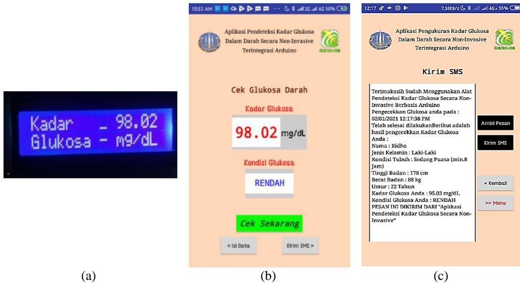
**Gambar 11. (A) Hasil Pengukuran Kadar Glukosa LCD Alat; (B) Hasil Pengukuran Kadar Glukosa Menu Pengecekan Aplikasi; dan (C) Isi Pesan yang akan dikirim**
