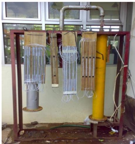
Gambar 3. Alat pengukuran *secondary flow* dan distribusi tekanan
