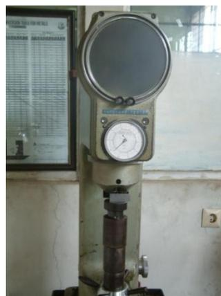
Gambar 3. Alat Pengujian Kekerasan *Rockwell*
