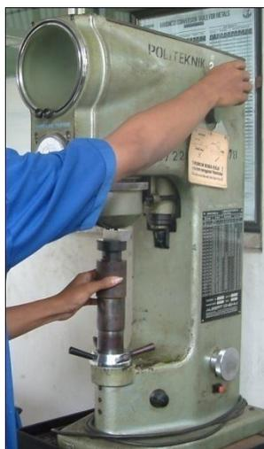
**Gambar 5.** Pengujian kekerasan dengan metoda *Rockwell*
